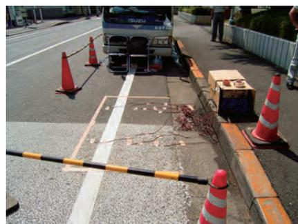
現道で路面温度を測定した結果です。保水性舗装を施工した箇所と、隣接する密粒アスコンとの温度差は、最大で 17.7℃を示しました。(試験日:2004年8月9日)
