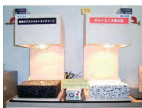
室温 20℃、湿度 70%の環境下における室内試験の結果です。舗装体表面温度は、密粒アスコンが 65℃程度になるのに対して、保水性舗装の場合は約 40℃までしか上昇しません。
