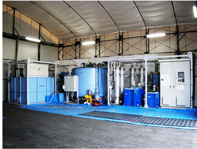
グリーンラスト／フェライト循環処理法による可搬型処理設備の全景
