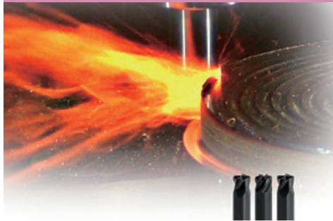
写真：航空機部品材料を削るセラミックエンドミル (明石製作所)
