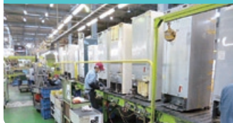
写真：冷蔵庫前処理（フロン回収等）工程（中部エコテクノロジー株式会社）
