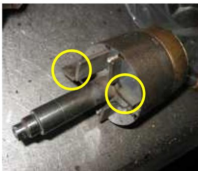
エアコンのコンプレッサーや冷蔵庫のモーターから高性能なレアアース磁石を回収し再資源化（写真 部がレアアース磁石部分）
