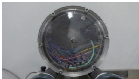
有機溶媒によって膨潤した電線剥離の様子
