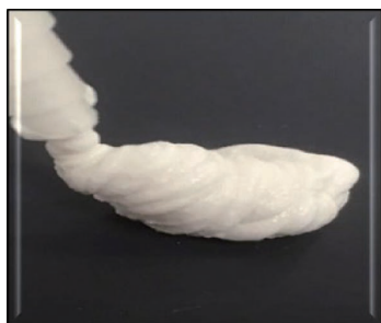
図 2 二液硬化型伝熱材料（ディスペンサー吐出直後） Two-component curable thermal interface material (immediately after dispensing from dispenser)
