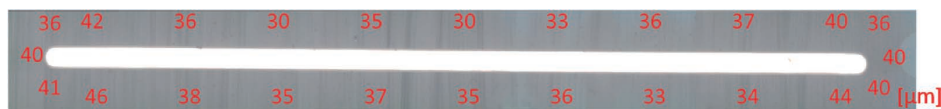
図4 平角線へコーティングした樹脂被膜の厚み。導体サイズ：0.42 mm×17.2 mm, アスペクト比 42.3。写真中の数値は、その箇所における皮膜厚さ Film thickness distribution on a flat conductor. Size of conductor is 0.42 mm×17.2 mm, aspect ratio is 42.3. Numerical values are film thickness at the indicated position in the figure
