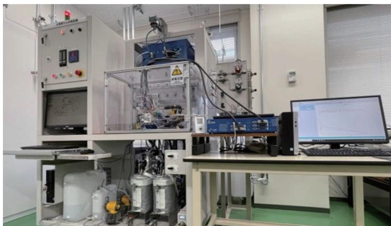
図 4 水電解評価装置の写真
