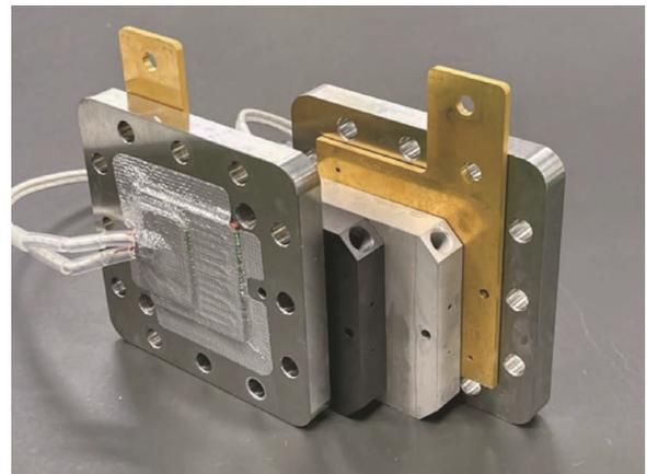
図3 PEM形水電解槽の写真
