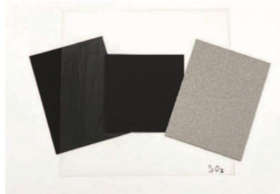
図2 CCMと電極の写真。左：カーボンペーパー，中央：CCM，右：MMC製チタン多孔質体
