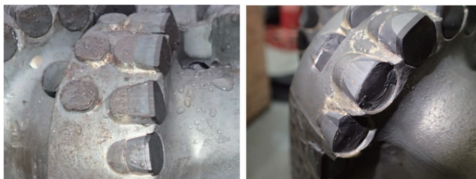
図 7 掘削後の PDC カッター損耗具合の代表写真 (左: PDC ビット 1, 右: PDC ビット 2)
