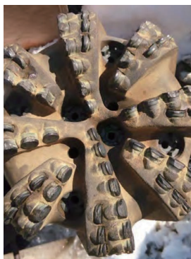
図 10 掘削後の PDC ビット 3 の刃面部外観写真 Photograph of PDC bit-3 after the field experiment.
