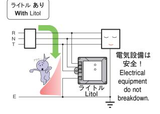
雷サージのエネルギーがそのまま電気設備などに到達し、 半導体部品の破壊など、故障につながります。
