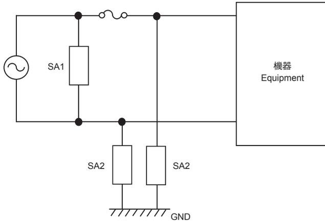
使用例：SW 電源、インバータ電源、OA 機器及び家電機器の電源
