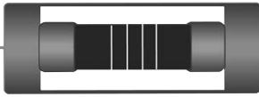
図6 マイクロギャップ式サージアブソーバ (リードタイプ) Fig.6 Micro-gap Surge Absorber (Lead wire type)
